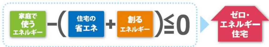
●ZEH(ネット・ゼロ・エネルギー・ハウス)の概要図
