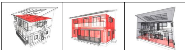
外皮性能向上(高性能断熱材+サッシ)
